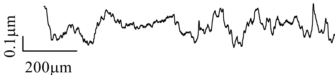
図 2.30 A1050-H24 の表面粗さ測定結果 ( 0^\circ ; Rz = 0.2 \mu\text{m} )
