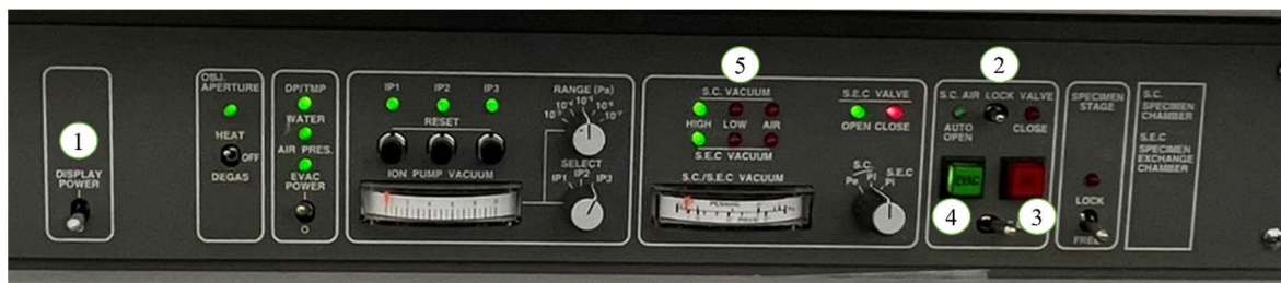
①[DISPLAY POWER]レバー ②[S.C. AIR LOCK VALVE] ③[AIR]スイッチ ④[EVAC]スイッチ ⑤[S.E.C.VACUUM]
