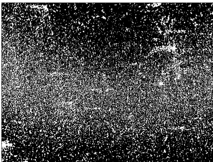
図 2.56 2 値画像 明るさ+10 コントラスト+70 (基板アルミフィルタ側表面粗さ 0.05\ \mu\text{m} 試験, アルミニウム, 試験期間 14 日)
