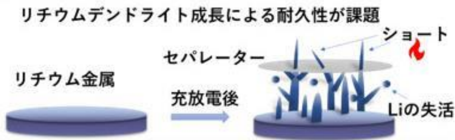
Fig.1.11 リチウム金属のデンドライド発生図 [13]
