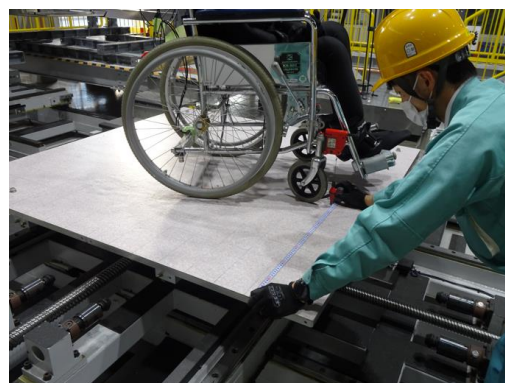
写真 5.6 加振後の移動位置の計測
