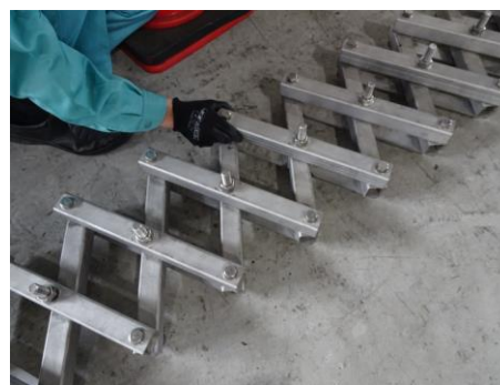
写真 5.4 伸縮装置の可動確認
