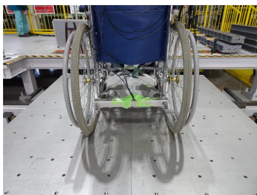
写真 5.5 車いすの加速度計取付位置
