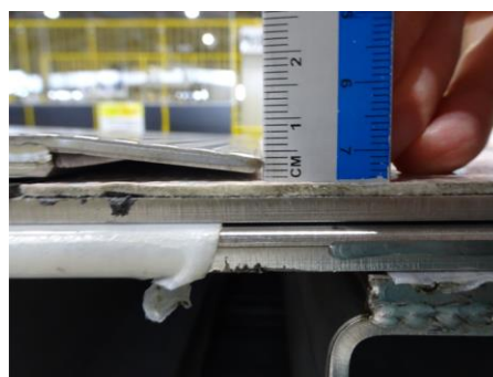
写真 5.2 本体パネル変形確認
