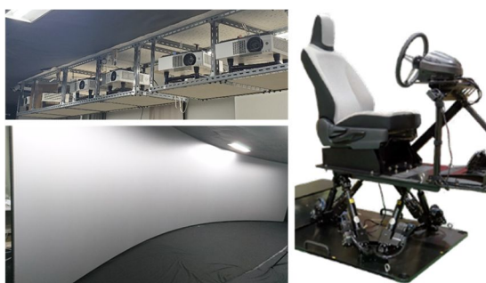
図 3-1: 3D ドライビングシミュレータシステムを構築する機材の写真。天井に 6 台のプロジェクタを設置(左上)し、円筒スクリーン(左下)に映像を提示した。ドライビングシートはムービングベース上のモックアップを用いた。
