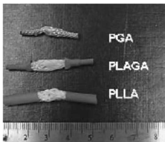
図 1-5 高分子ポリマーに編組構造を持たせた足場 19)
