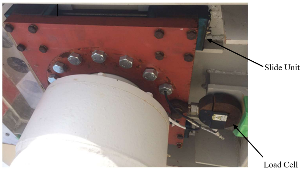
(b)ロータ推力測定装置の下面写真
