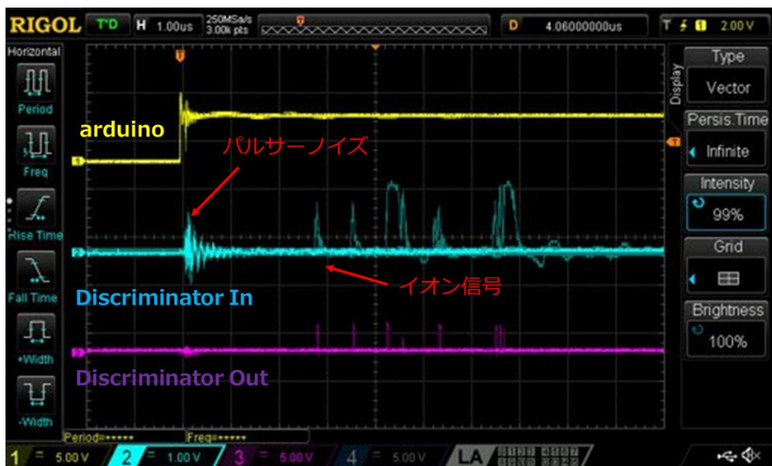
図 3-8 閾値調整後のディスクリミネータの入出力
