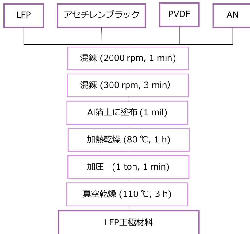
Fig. 2.3.1.LFP 正極材料合成のフローチャート
