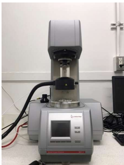
Fig. 19 レオメータ MCR302 (Anton Paar 社)
