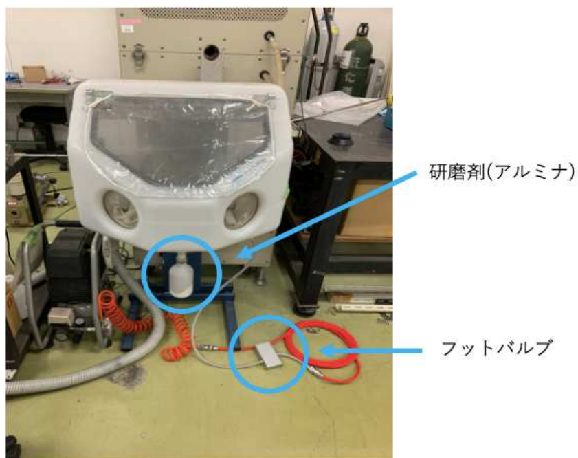
図 3.5 サンドブラスト装置
