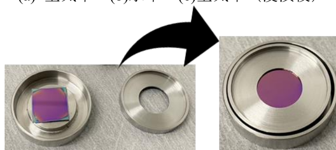
Figure 6-6. SPM 測定の液中観察用セル
