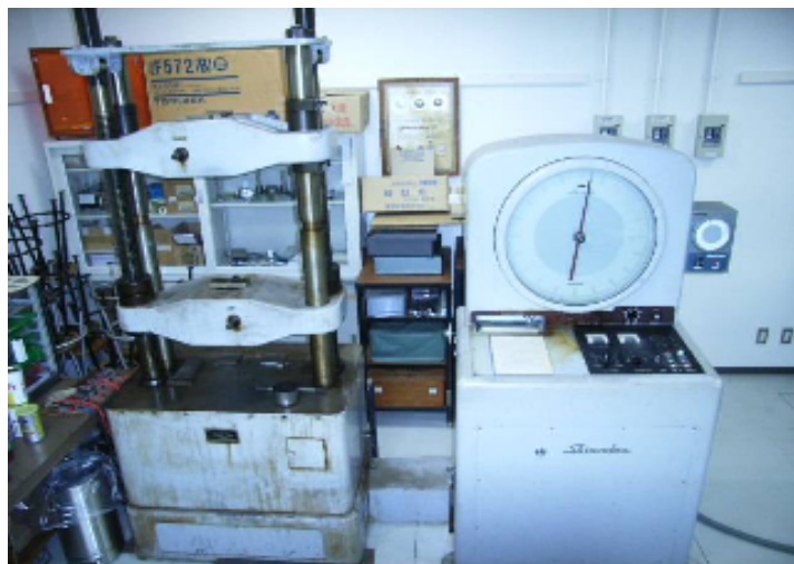
Fig.2.18 万能試験機（島津製作所製，REH-50 型）
