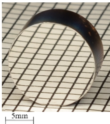
Fig.2.11 研磨後の工具表面 (Tool-2)
