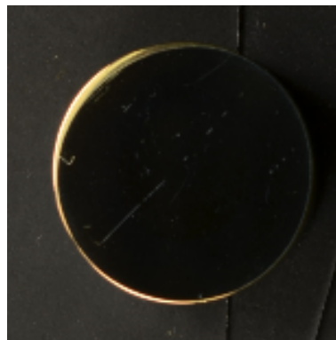
Fig.3.47 圧縮後工具表面 (DLC, Tool-2, A5052-O, e_c=15\% )
