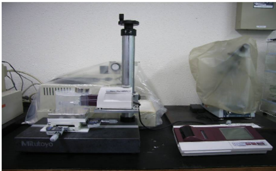
Fig.2.33 触針式表面粗さ計（Surftest SJ-400）の外観
