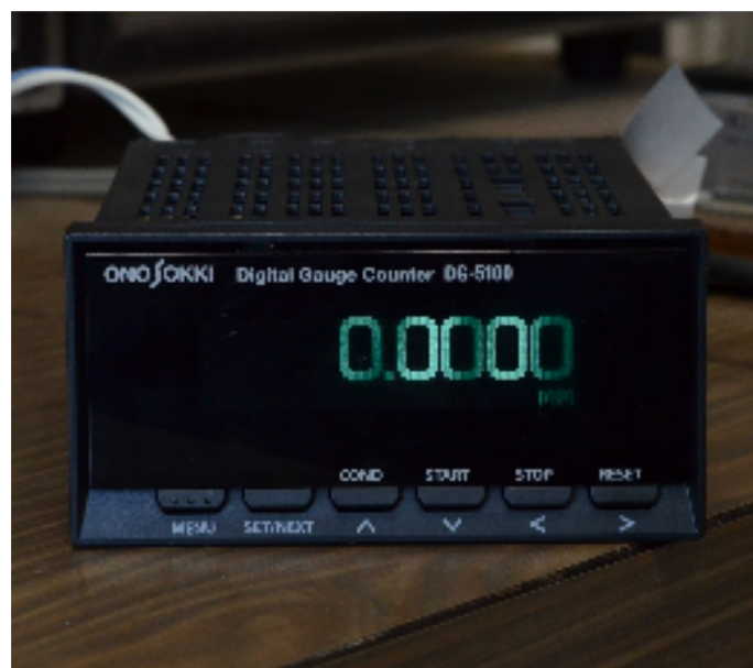
Fig.2.21 デジタルゲージ (ONO SOKKI 製 Digital Gauge Counter DG-5100)
