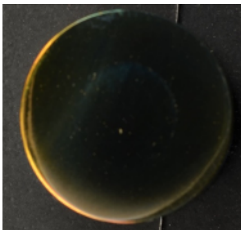
Fig.2.37 圧縮後工具表面のデジタルカメラ像の一例 (DLC, Tool2, A5052-H, e_c=49\% )
