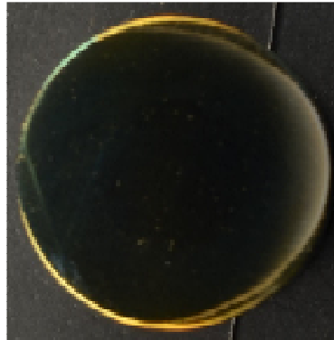
Fig.3.17 圧縮後工具表面 (DLC, Tool-2, A5052-H, e_c=37\% )
