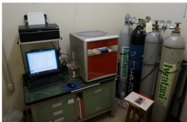
図 3.2.6 CHN 元素分析装置
