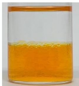
Fig. 5 メチルオレンジの抽出実験
