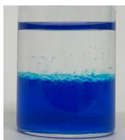
Fig. 3 ブリリアントブルーFCF の抽出実験
