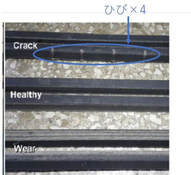
図 16 ひびを付与, また摩耗させたベルト[30]
