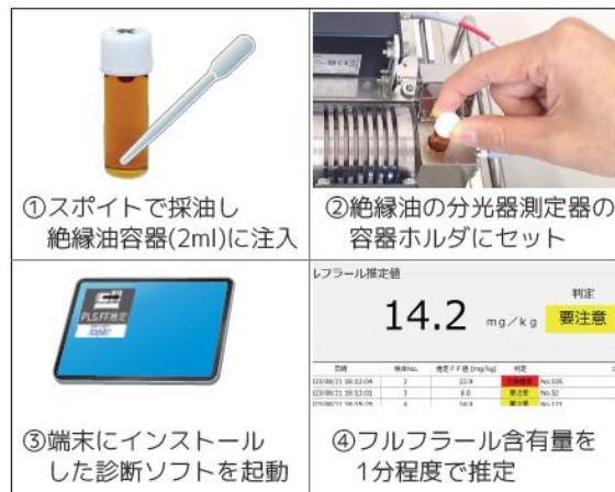
図 4-15 現地診断装置の分析の流れ
