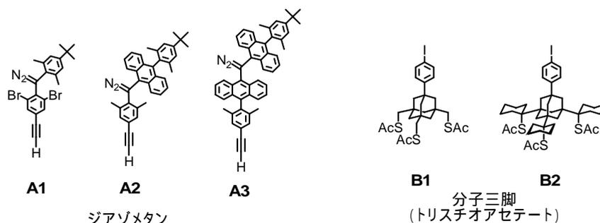
(2) 上記調製のジアゾメタンと分子三脚を連結し、続いて脚を SAc から SH に変換することにより、ジアゾメタン-三脚形トリチオール連結体を合成する。得られた連結体の溶液に Au 基板を浸漬し、基板表面に自己組織化単分子膜 (SAM) を作製する。
