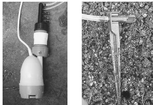
図6 給水に使用した家庭用バスポンプ（左）と灌水用点滴ノズル（右）
