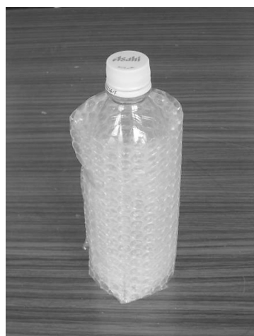
写真2 断熱材を巻いたペットボトル
