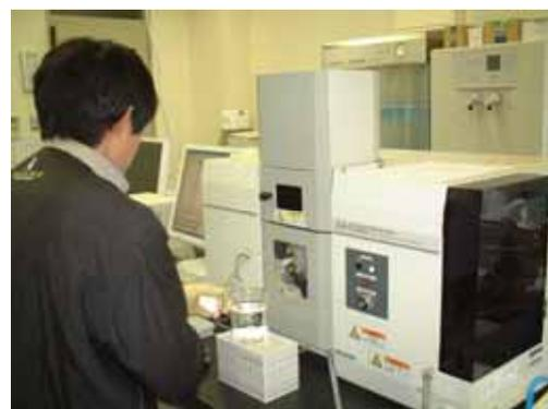
写真2 原子吸光光度計による測定
