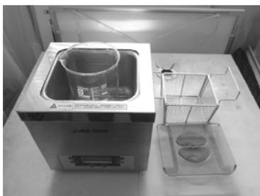
写真 4 超音波洗浄機
