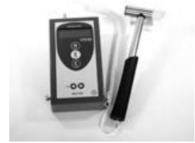
(d)機械インピー ダンス式ハンマ法
