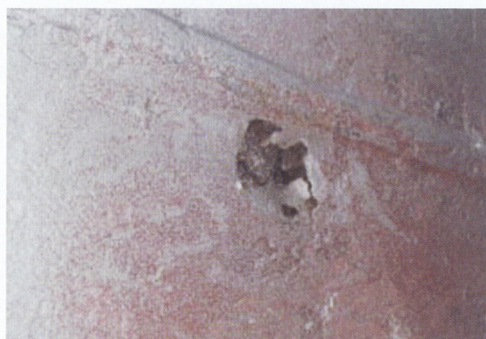
写真3 船腹に開いた直径約1 cmの穴（2003年）
