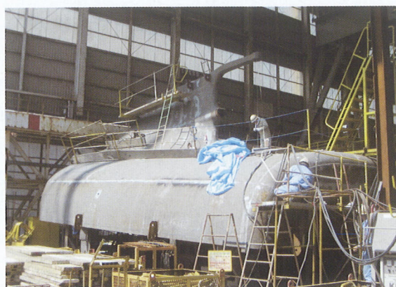
写真9 上下反対にして作られる船体後部。上方に突き出ているのは舵の取り付け部分。
