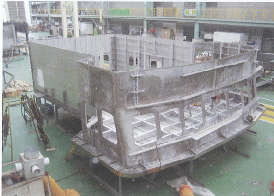
写真10 上下反対にして制作されているアルミ製ブリッジ
