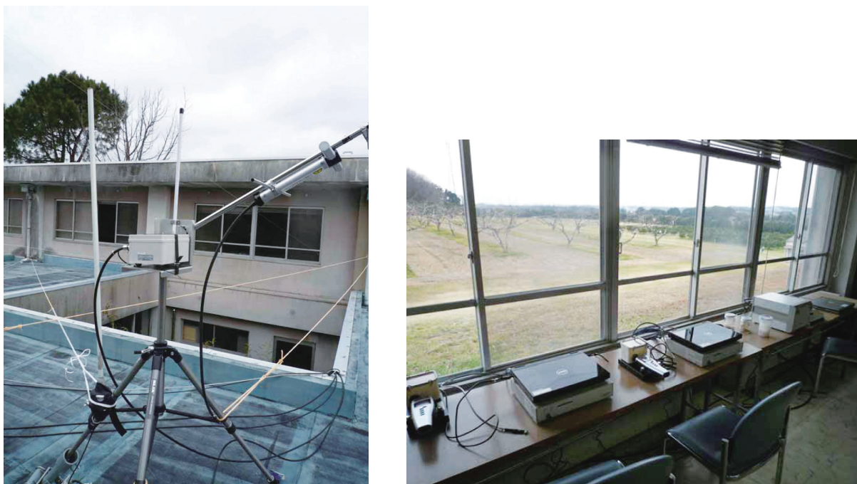
図6 上空のラジオゾンデから発信された電波を受信するアンテナ。(左写真) 受信機と処理 PC。黒色の PC の下にあるクリーム色の装置が受信機。 その右隣にある装置が地上温度と湿度のチェック機器。(右写真)
