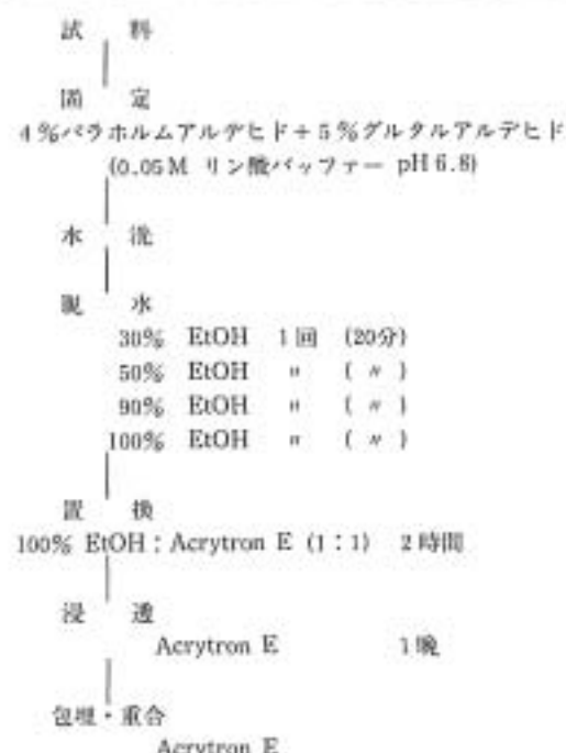
第33図 光顕用プラスチック樹脂 (Acrytron E) による試料包埋までの手順
