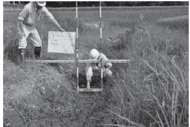
図7 排水路落成検査
