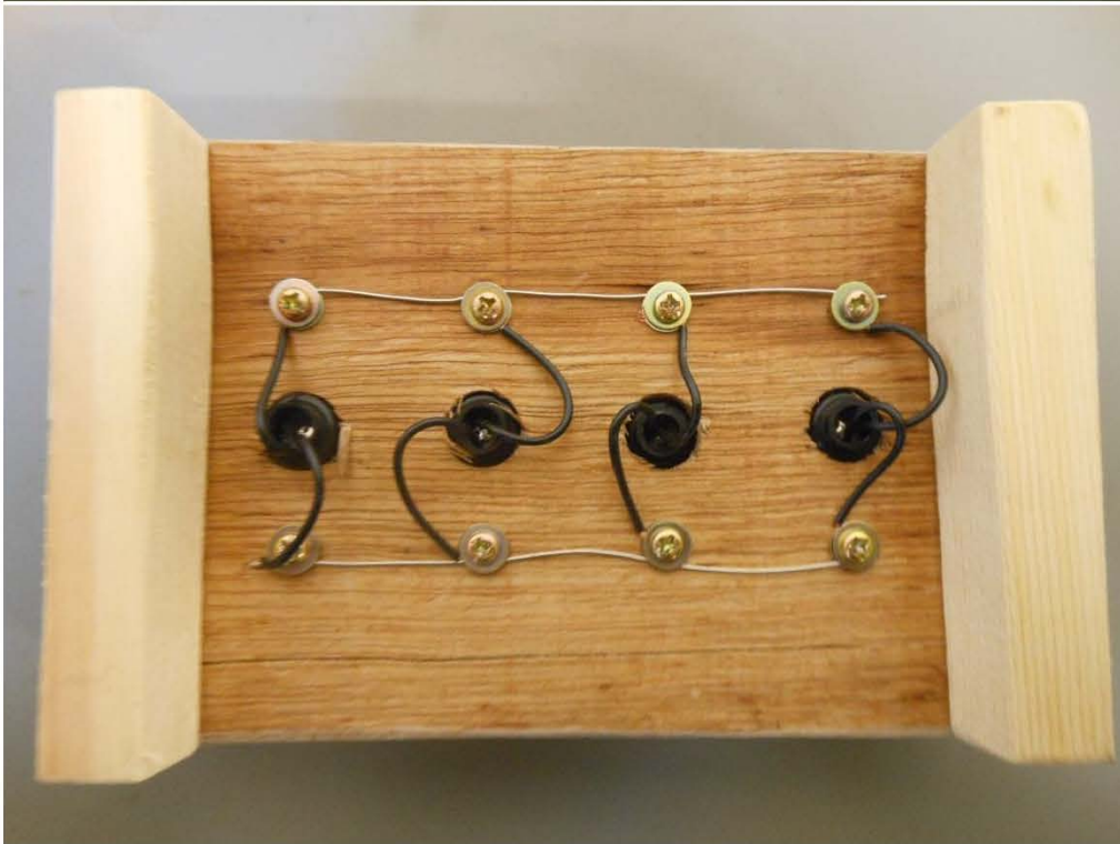
図 7 豆電球を用いた手回し発電の負荷教材
