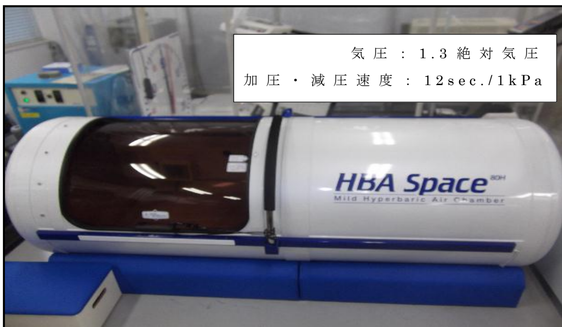
写真 3 高気圧エアー・チャンバー（日本ライトサービス株式会社製 HBA-SPACE 80H）
