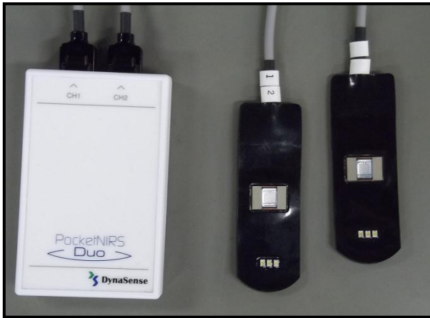
写真 5 携帯型近赤外線組織酸素モニタ装置（株式会社ダイナセンス社製 PocketNIRS Duo）
