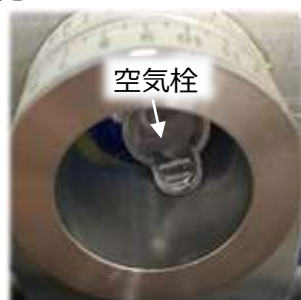
図 5-8. 空気栓が引っ込んだ様子
