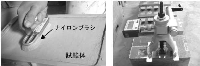
写真1 粉体の採取方法
