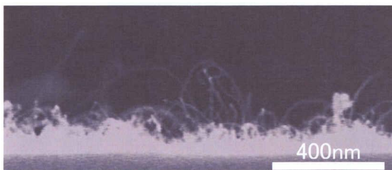
図 4-2-1 Co(2nm)/Si 基板で成長させた CNT の SEM 像
