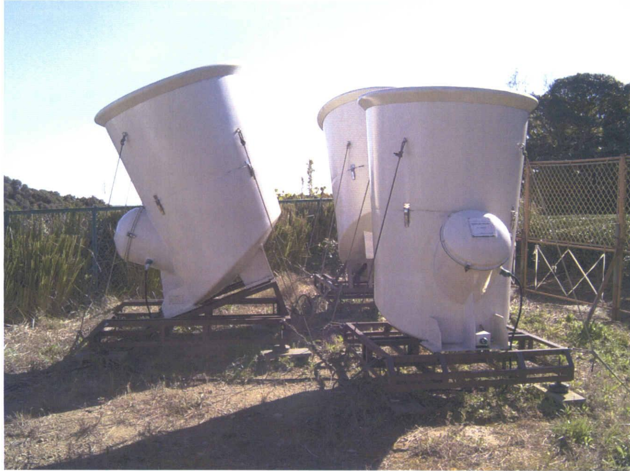
図 1.1 モノスタティック型ドップラーソーダ
