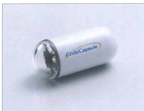
Fig XI : 高い演色性を持つ LED が必要なカプセル型内視鏡
