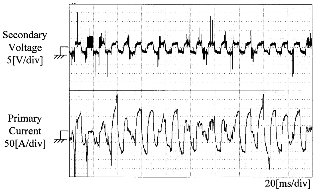
図 5-2 電圧・電流波形 (①ファイナル過程 I_{ref}=109.2[A] , R_{ref}=1.2[m\Omega] )
