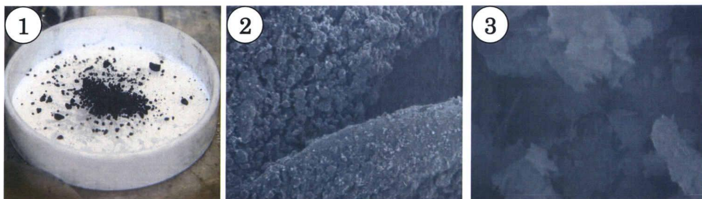
Fig.3-4-3 リチウムードデカン HEMM 処理後 Li の通常写真(①)と SEM 結果(②、③)
