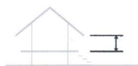
図 3.38 床面と軒先の間の鉛直距離
