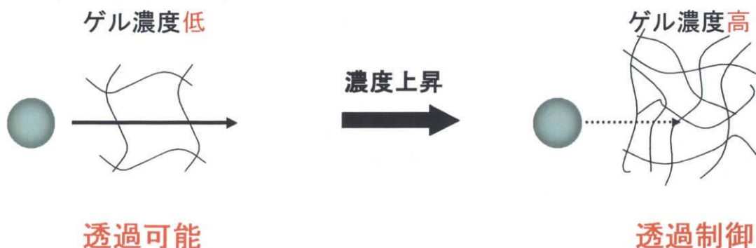
Fig2-2 ゲル濃度による透過制御
