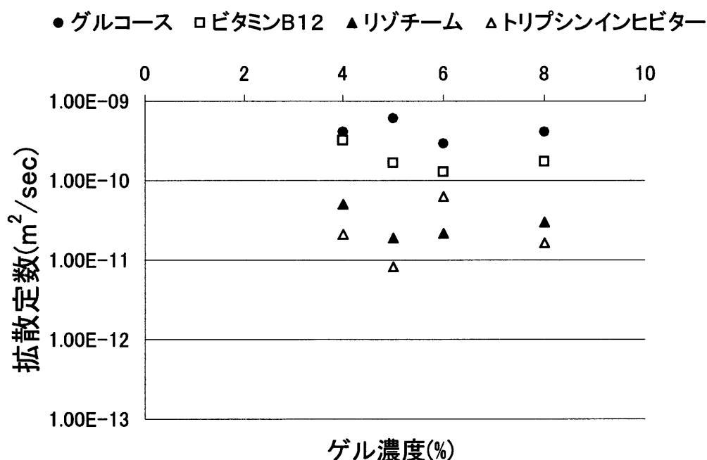
Fig2-8 分子半径による拡散定数の変化
