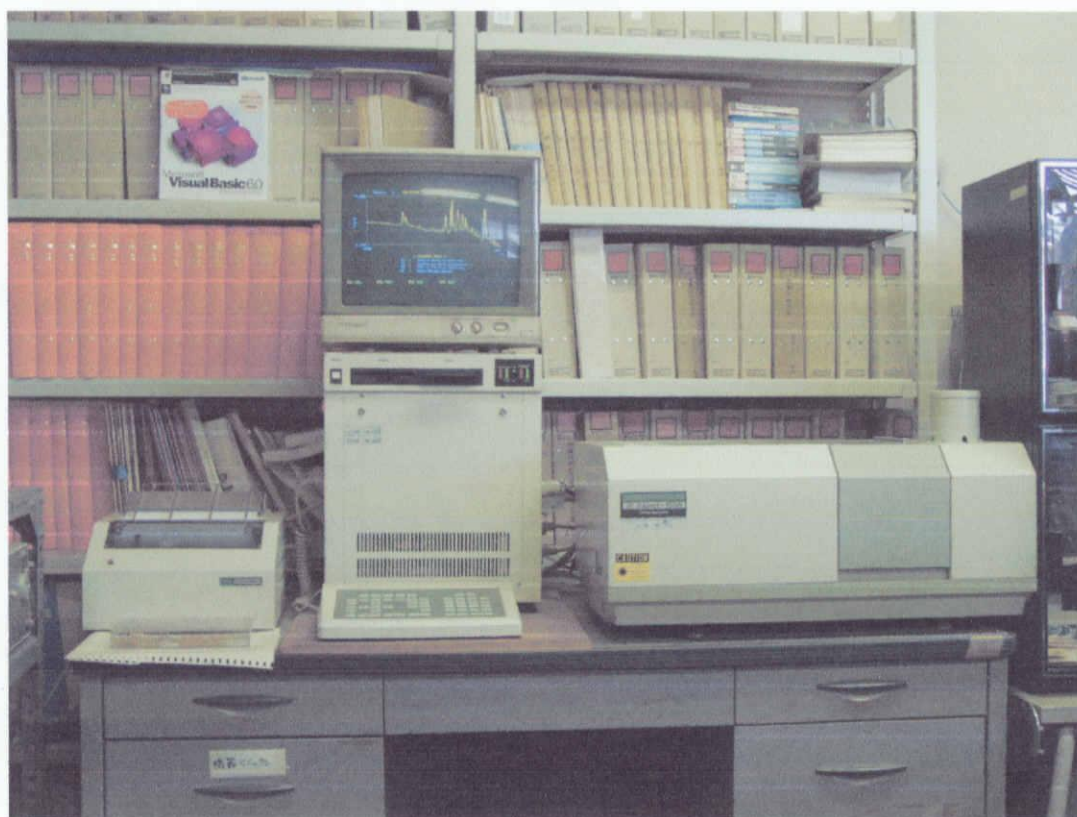
図 3-6 FT-IR7000 赤外分光光度計
