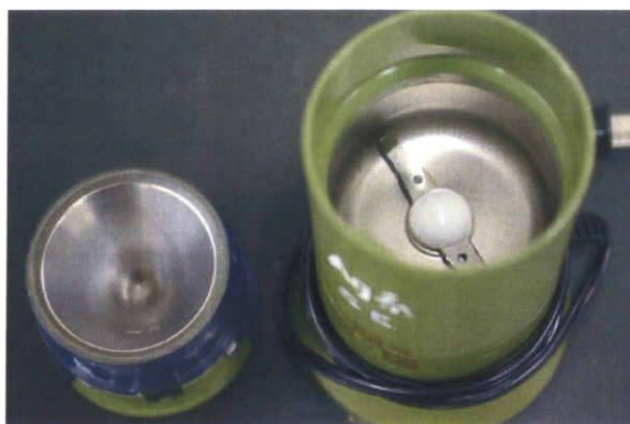
Fig. 2-28 バインダー入り試料の粉砕に用いたミルサー
