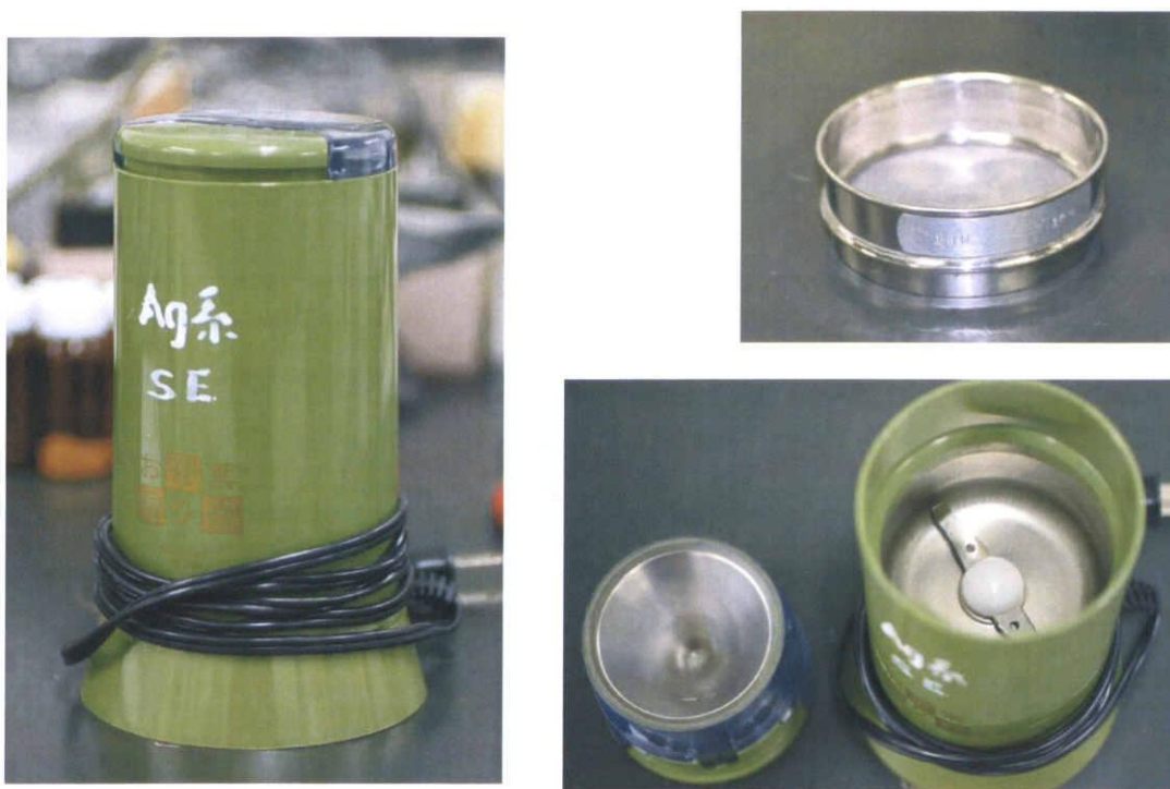
Fig. 3-3-11 バインダー混合に使用したミルサーとフルイの写真
