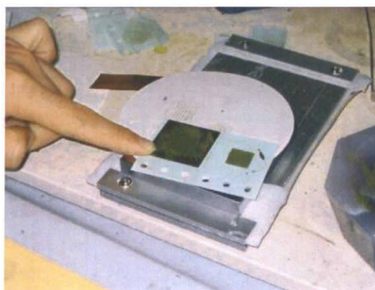
Fig. 3-3-15 湿式法による電極膜の作製工程の写真
