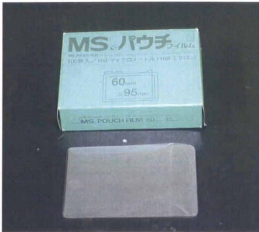
Fig. 2-21 ラミネートセルに使用したパウチフィルム
