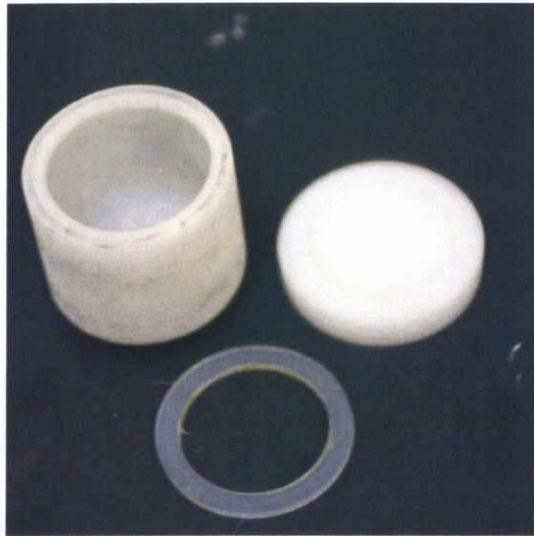
Fig. 2-4 ソフトボールミル混合に使用したテフロンボールミル容器とシリコーンリング
