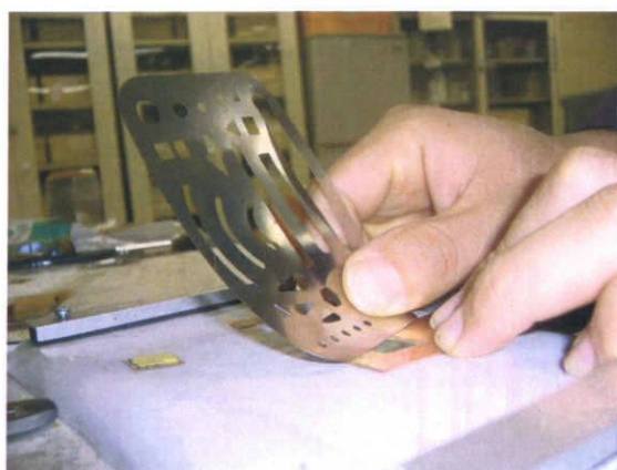
Fig. 3-3-15 湿式法による電極膜の作製工程の写真
