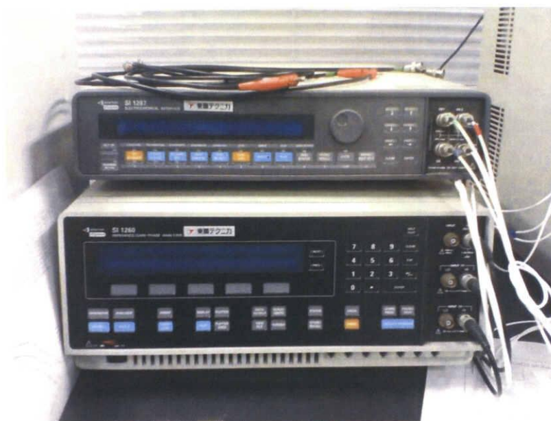
Fig. 2-35 本研究において CV 測定・インピーダンス測定・パルス電流試験を行った装置 英国 Solartron 社製 IMPEDANCE/GAIN-PHASE ANALYZER Solartron SI1287
