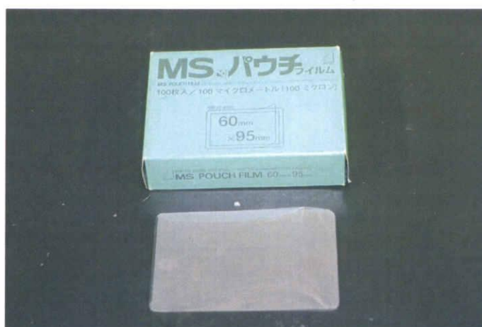
Fig. 3-3-14 ラミネート化に用いた MS.パウチフィルム
