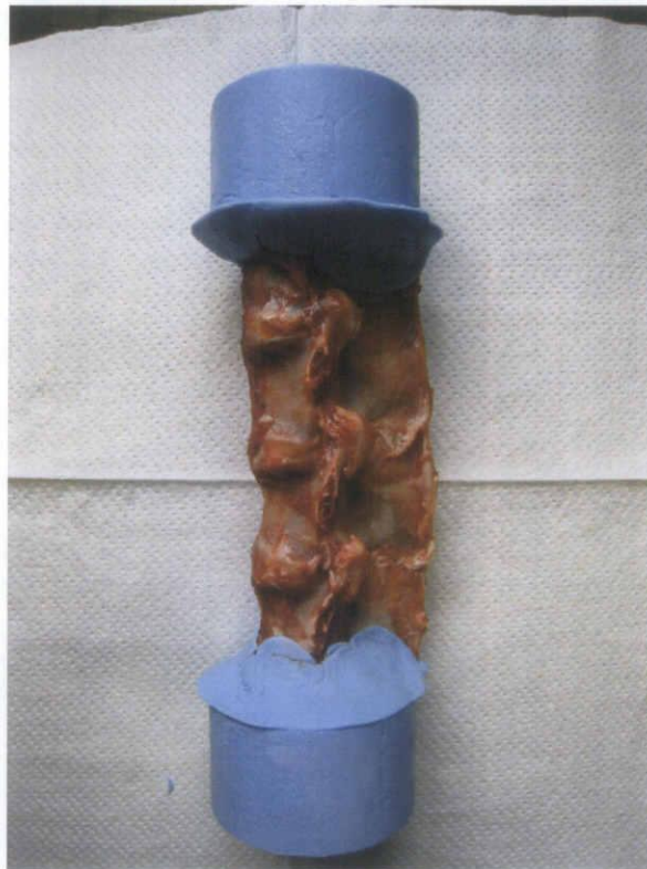
図 4.7 固定用樹脂固化後
