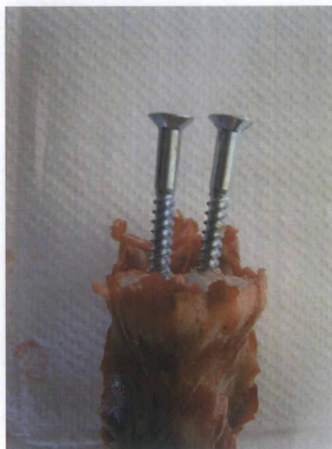
図 4.6 固定用ネジ挿入後
