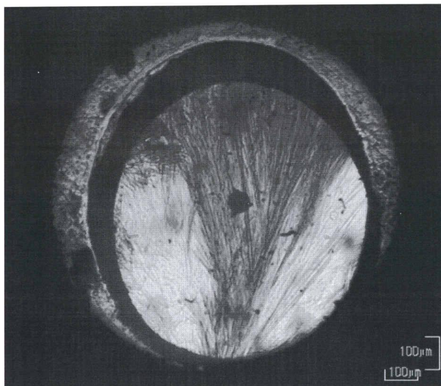
図 4-22 nAA (3) で 1.75GPa 前後を目標に加圧した際の圧力室
