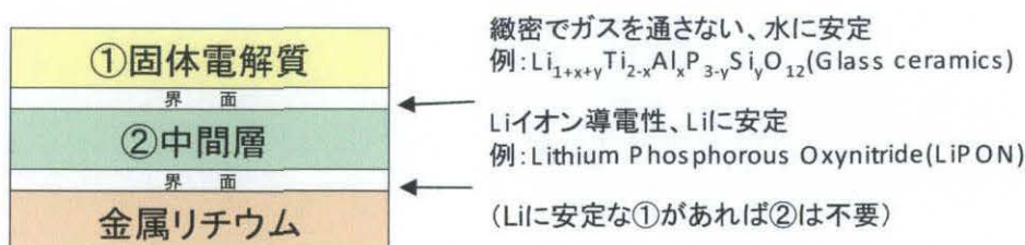
図6 リチウム/被膜積層型負極
