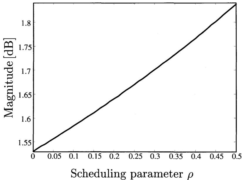
図 7.4: 周波数  $\omega = 0.01$  rad/s での制御対象のゲイン
