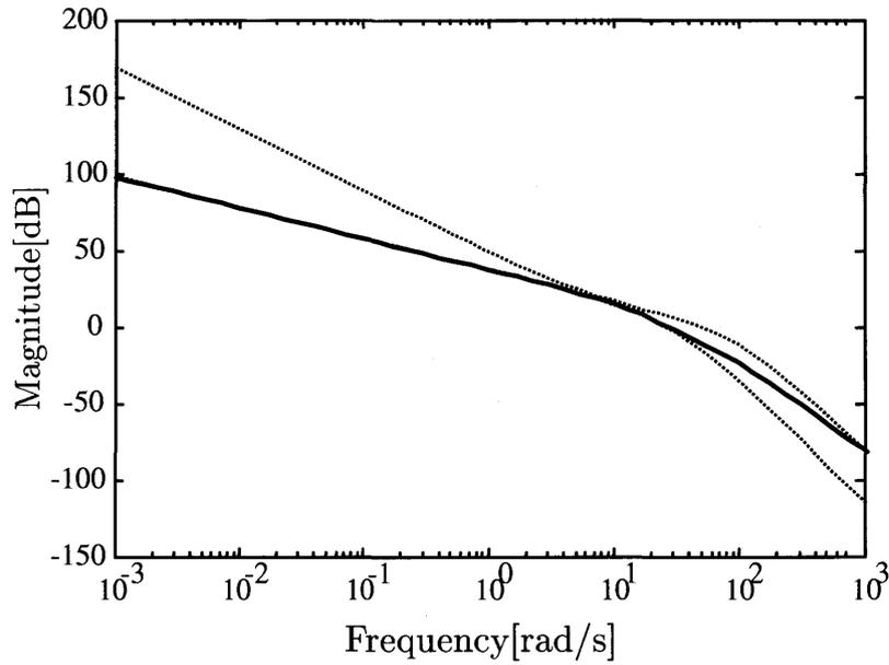
図 7.3: 設計点  $\rho = 0$  での拡大プラントのゲイン特性
