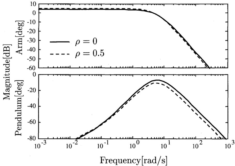
図 5.11: 鉛直型倒立振子のゲイン特性
