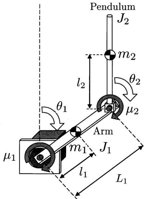
図 5.10: 鉛直型倒立振子
