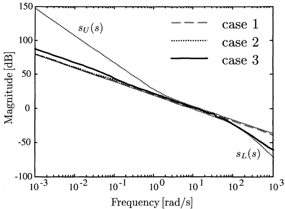
図 6.3: 拡大プラント  $P_W(s)$  のゲイン特性
