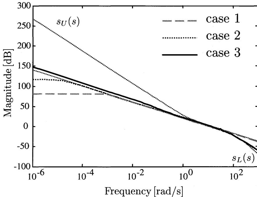
図 6.4: 拡大プラント  $P_W(s)$  のゲイン特性
