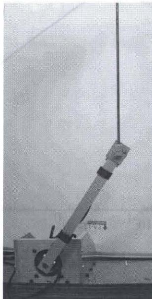
図 5.9: 鉛直型倒立振り子
