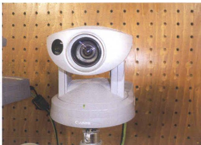
図 9 可動視野カメラ(VB-C50i)
