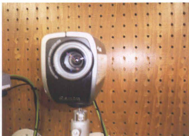
図 10 固定視野カメラ(VB-C50Fi)
