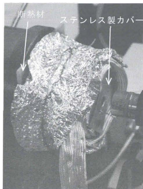
図 3-16 断熱用アルミホイルを巻き付けた DAC
