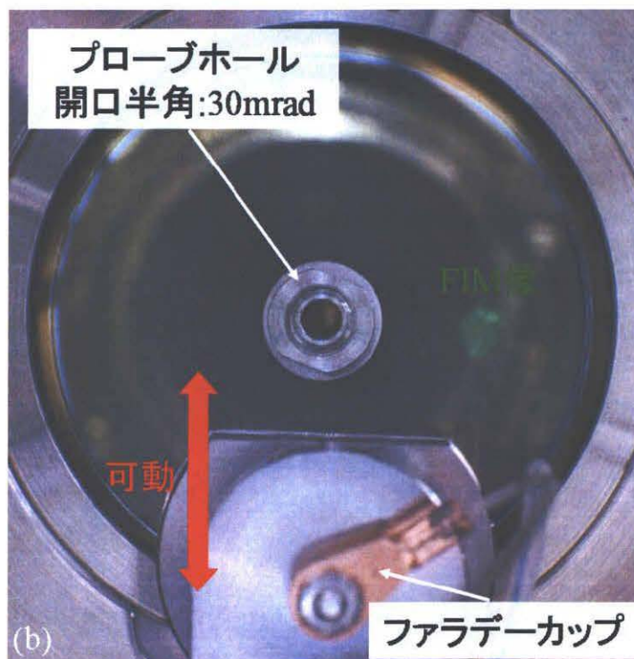
図 3-2 イオン電流測定機構。(a):模式図 (b):MCP およびファラデーカップの写真
