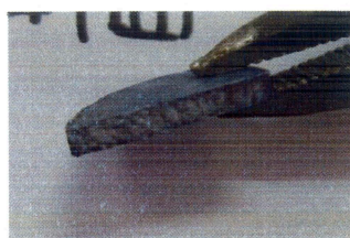
Fig.2-3-2 焼結体 \text{Li}_x\text{Ti}_5\text{O}_{12} の断面の観察
