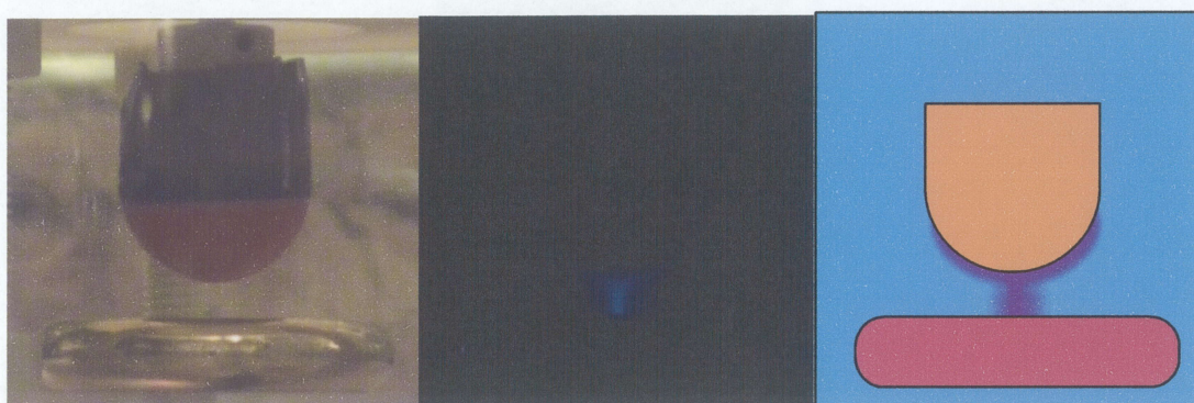
放電開始前の電極系図 放電開始時の発光 発光モデル図
