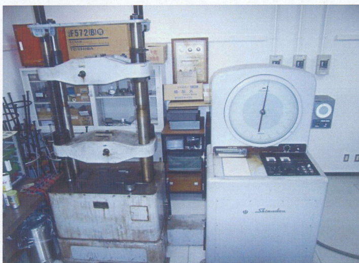
Fig. 2.25 万能試験機(島津製作所製, REH-50 型)
