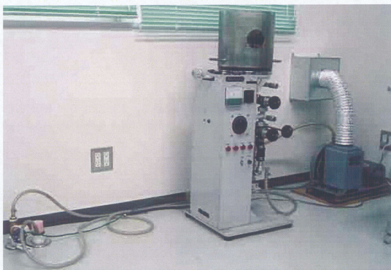
Fig. 2.21 真空蒸着装置の外観
