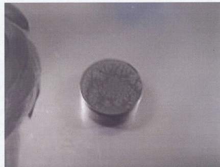
Fig. 2.15 研磨中の工具表面(WA#4000)
