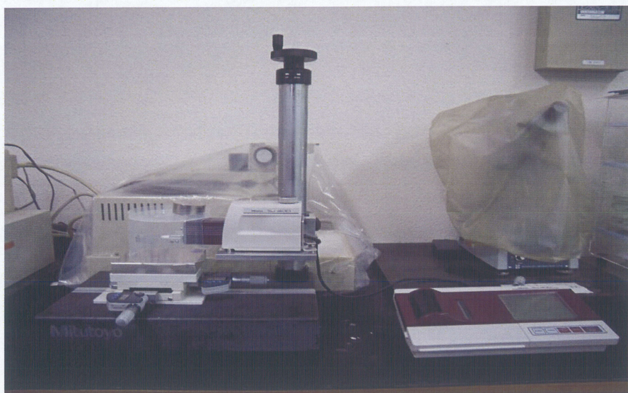
Fig. 2.27 触針式表面粗さ計(Surftest SJ-400)の外観
