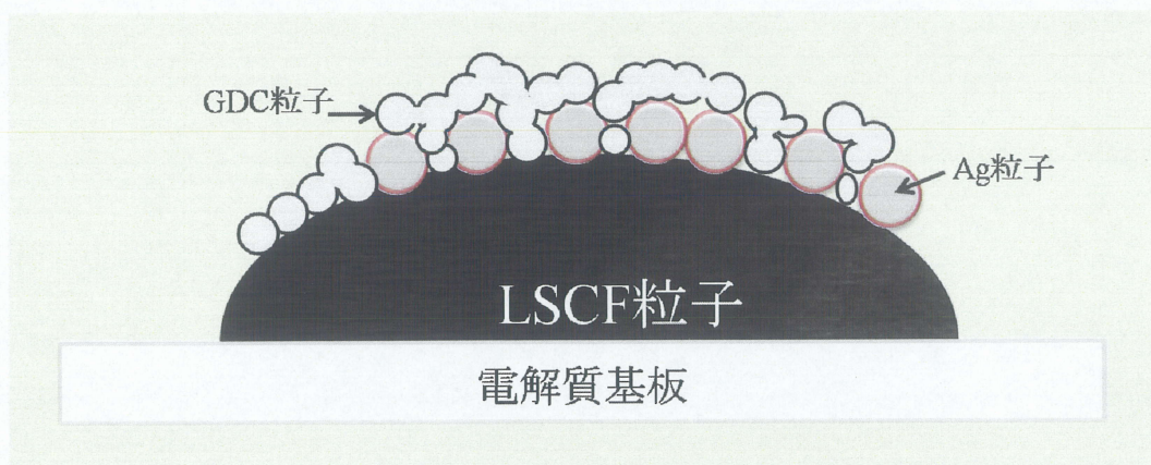
Fig. 3. GDC 粒子による Ag 粒子成長抑制原理
